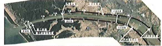
流下能力が不足し、抜本的な改修が必要な大河津分水路
