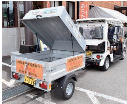
実験で使用した6人乗りと荷台付き4人乗り（下）の車両。道路中央の黒い部分が電磁誘導線
