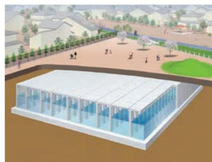
来年度中の供用開始を目指し、琴平2丁目の「琴平つくしんぼ公園」地下に建設する、市内初の巨大貯留施設もその一つ。内部の高さは約4m、貯留量は2、800m<sup>3</sup>で、25mプール約8杯分の雨水を貯めることができます。これにより、東新町地区と琴平地区の浸水被害を減らせるようになります。
