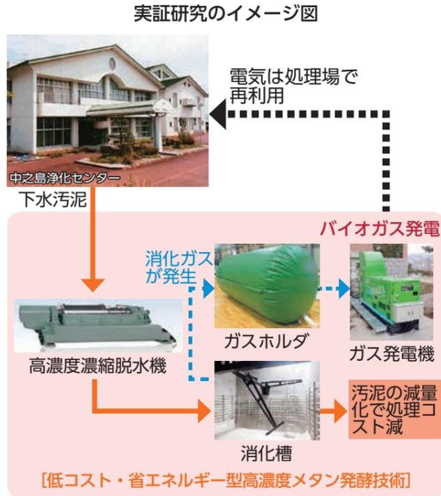
「発酵技術」です。下水汚泥からガスを発生させる装置などを一体的に小型化するもので、電力費の削減や汚泥の減量化を可能にします。今年度から2年間、中之島浄化センターで実証研究を行います。
