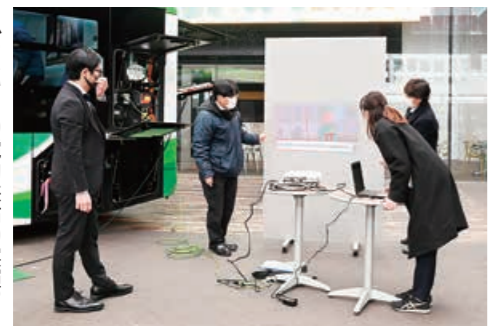
▶バスからの電力供給の実演。ACコンセントや車内のUSB電源から直接利用できます。
