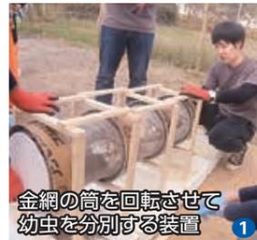
金網の筒を回転させて幼虫を分別する装置
