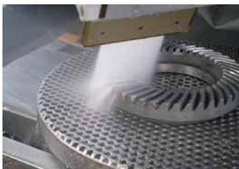
以下の細かい加工に対応できる世界でもまれな同社独自の技術。噴射スピードや研磨材の種類を変えることで、さまざまな素材に合わせて「洗う・磨く・削る」の処理ができます。油やさ
