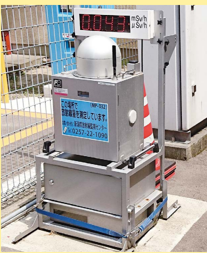
▲放射線量を測定するモニタリングポスト (市内64か所に設置)※令和8年4月現在
