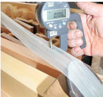
↑ 測定器で測ります。(写真のうす削りは6ミクロン)
