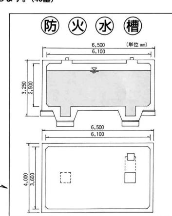
万一の火災に備えて40㎡級の防火水槽を整備しま す。40㎡の水があればポンプ1台で約70分放水でき ます。(40基)
