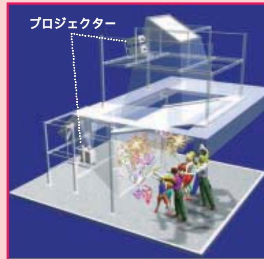
図2 シアターの仕組み 円偏向光とは通常の光に左右別々のネジリを加えたものです。
