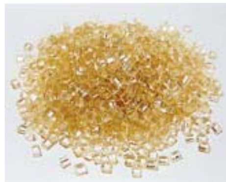
長岡市のペットボトルからつくったペレット（ペットボトルを細かく粉碎した後、溶かして粒状に固めたもの）ペットボトルの汚れが少ないほど透明になりますが、長岡市のは...
